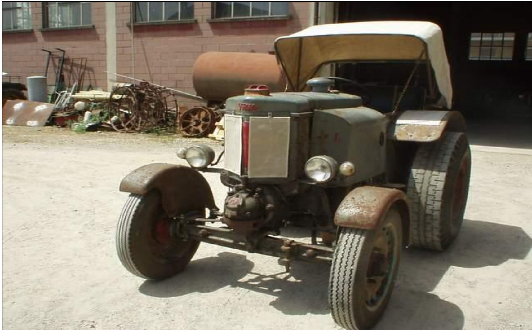
Le tendine anteriori non permettevano l'eccessivo raffreddamento del motore
