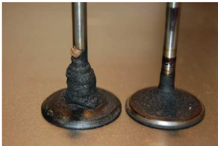
Plastiche e gomme sciolte dall'etanolo con residui depositati sulle valvole di un motore fuoribordo
