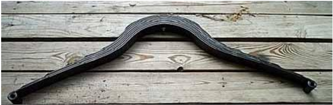
La ristrutturazione della balestra ellittica posteriore da : www.cimorelli.com
