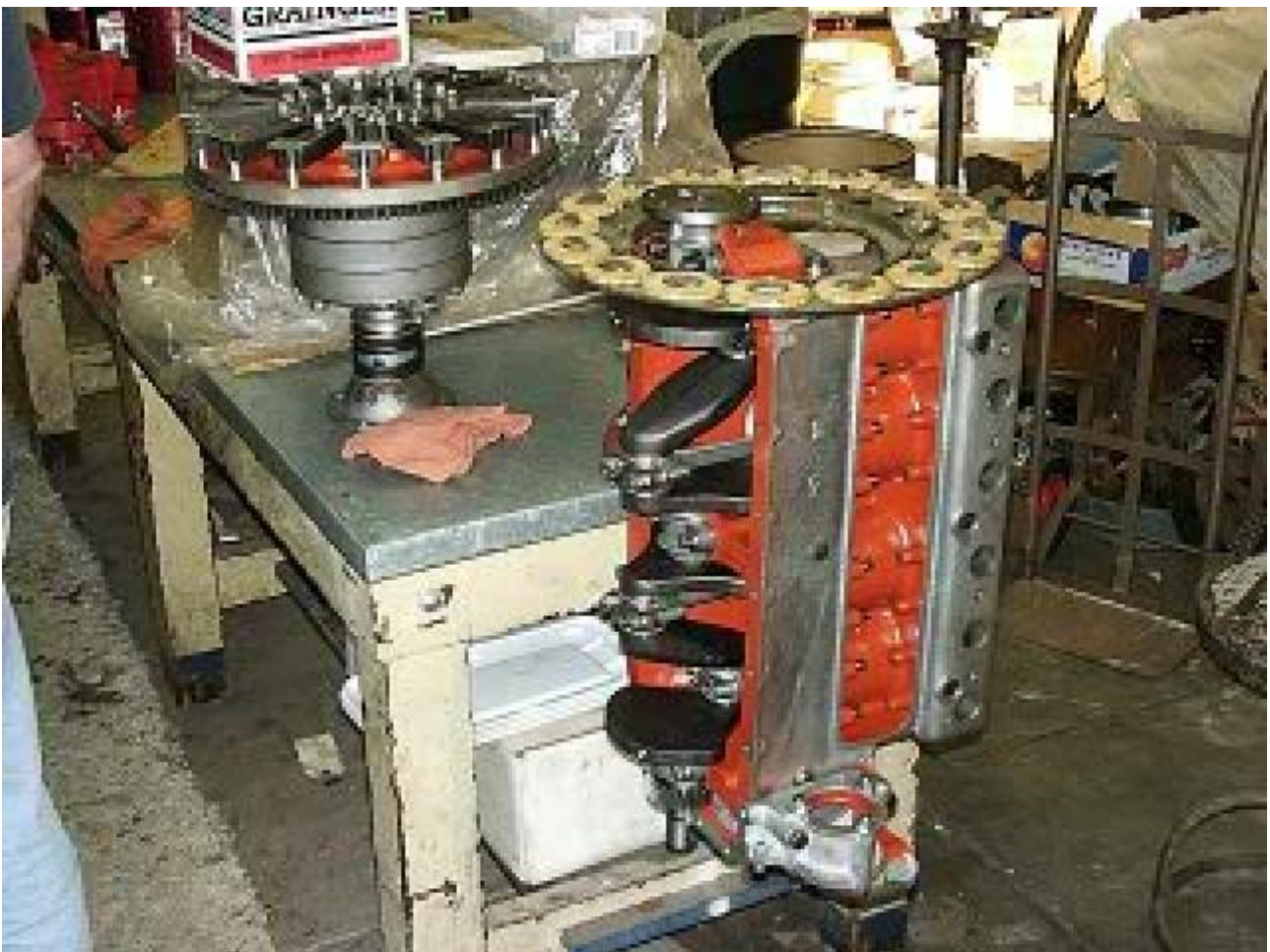
Albero motore , monoblocco , volano magnete – Da : www.modeltford.net
