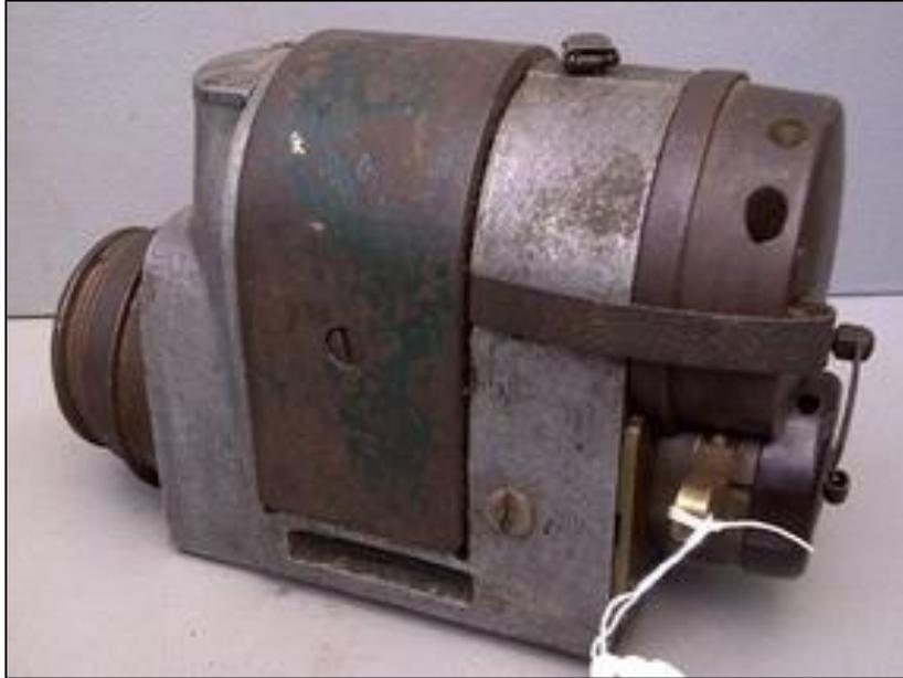
Un BOSCH FU4B usato per il trattore **Fordson F.** (4 cilindri)
